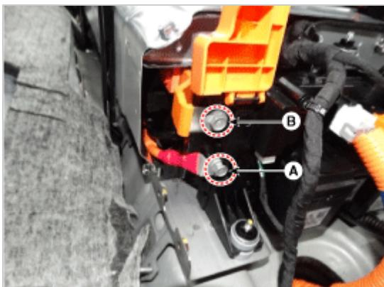
8. 分离BMS ECU延伸连接器(A)、蓄电池电流传感器连接器(B)、逆变器电源连接器[-](C)、逆变器电源连接器[+](D)和电源继电器总成连接器(E)。
